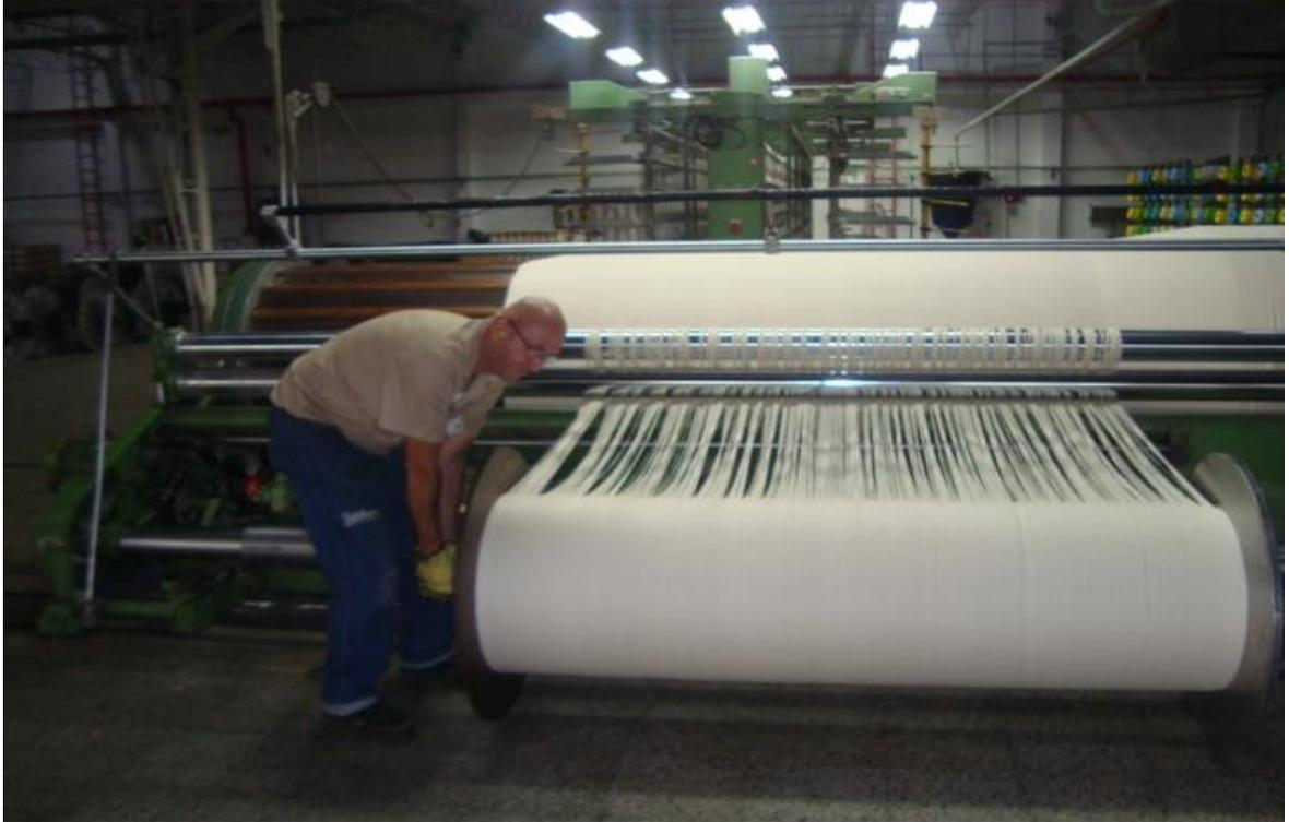
*En esta foto se observa un operario tratando de mover maquinaria pesada, requiere movimientos repetitivos causando posibles lesiones ergonómicas.*
