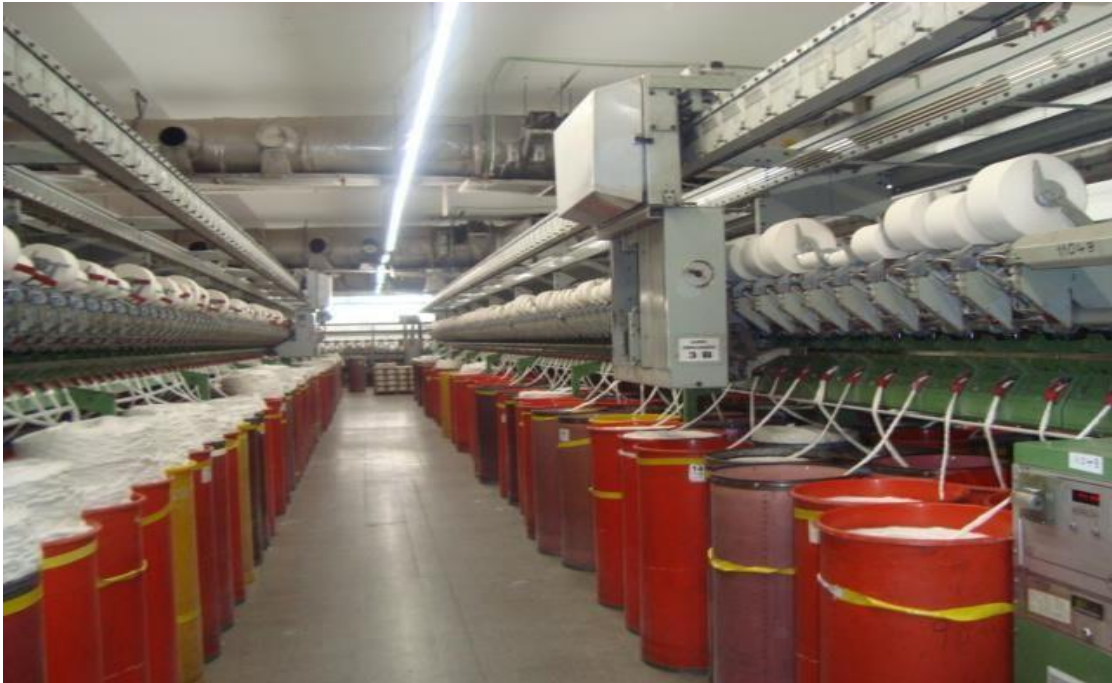
Maquinaria que separa el algodón que esta en los tanques, para hacer una fibra de hilo.
